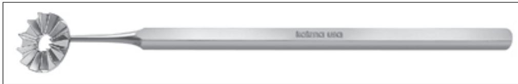
Descripción: Marcador radial Anis de 4 mm de apertura central y 12, 5mm de diámetro externo y 16 cuchillas.
